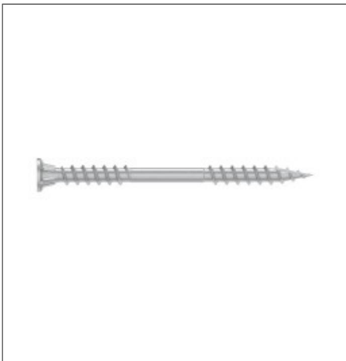
La vis CLS, conforme au DTU 41.2, a été conçue pour l'assemblage d'éléments bois tels que les bardages claire voie ou clin. Elle peut aussi être utilisée pour la fixation de lames de terrasse et de garde-corps en bois. En inox A4, cette vis assure une excellente tenue en extérieur, y compris en milieux salins et chlorés et résiste à toutes les essences de bois, y compris les bois traités.
