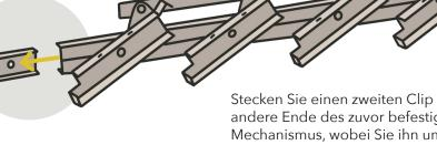
Stecken Sie einen zweiten Clip in das andere Ende des zuvor befestigten Mechanismus, wobei Sie ihn um mehr als die Hälfte herausstehen lassen sollten. Befestigen Sie ihn wiederum mit einer INOX-Schraube D5.
