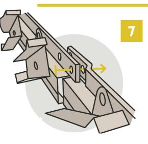
Verbinden Sie die beiden Mechanismen mithilfe von Nieten (oder Bolzen) und achten Sie darauf, dass der völlig gerade Teil vor dem leicht gebogenen Teil liegt. Setze den Vorgang bis zum Ende des Feldes fort und beginne dann erneut symmetrisch.
