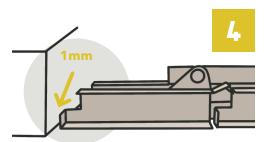
Clipsen Sie den SUNDIY-Mechanismus ein und schieben Sie ihn dann auf den Clip, wobei Sie zwischen dem Anfang der Struktur und dem (geschlossenen) Mechanismus einen Abstand von ca. 1 Hinweis: Dieser Satz wird nur für den Startmechanismus eines jeden Feldes benötigt.
