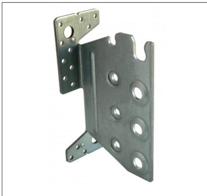
L'étrier TUB à âme intérieure permet un assemblage invisible. L'encoche en tête facilite la pose sur le chantier.
